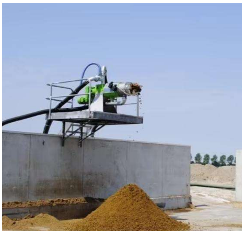
Separador de sólidos (una de las tecnologías posibles por centrifugado)
